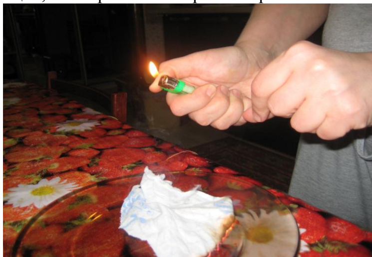
7. Демонстрация, как горит ткань и рвется при сильном натяжении.
